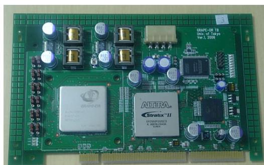
図 2: GRAPE-DR チップレイアウト (左) とチップ評価ボード (右)
