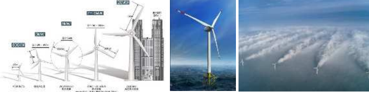
風車の大形化(直径200m:20MW) 洋上風車(2015年) 大規模洋上ウインドファーム 日本経済新聞電子版2013年7月18日 三菱重工エクスプレス No. 5427号 K.S. Hansen, EERA DeepWind 2014, 2014
